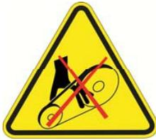
Etiqueta de advertencia e indicación de la posición de las poleas y la correa de la máquina.
