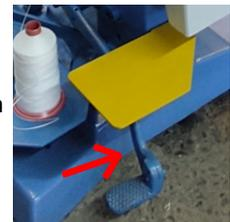
3. Para comenzar a coser, con el pedal en su posición inicial, el operador debe presionarlo. La máquina comenzará a funcionar.
