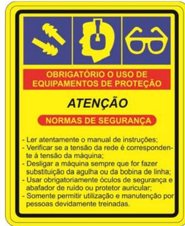
Etiqueta de advertencia para el uso obligatorio de EPI durante el funcionamiento de la máquina.
