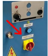
c) Presione el BOTÓN DE EMERGENCIA, debe bloquearse. Gire la perilla en el sentido de las agujas del reloj para desbloquearla. Déjelo en la posición «desbloqueado» para permitir la verificación interna del funcionamiento de los componentes eléctricos de accionamiento.
